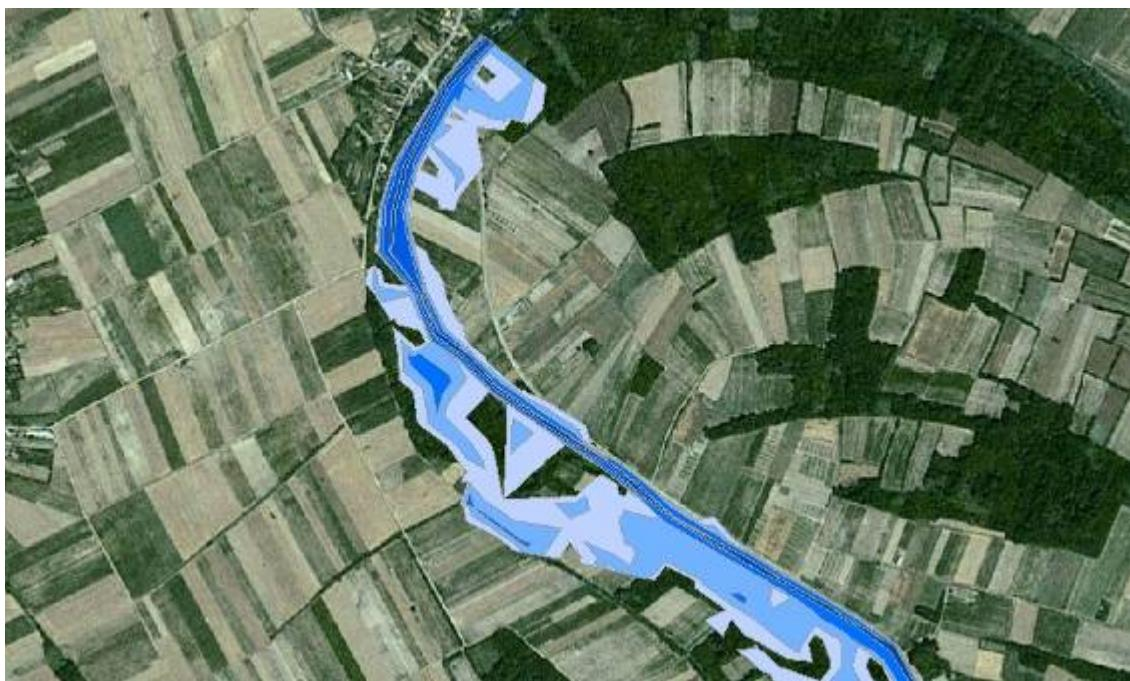
Karta 15 . Detalj sa karte 13, pokazuje rezultate plavljenja prilikom variranja nivoa vode na brani 2 Ćuprija: 75 m a.s.l. ; 76 m a.s.l. ; 77 m a.s.l. ; 77.5 m a.s.l. and 78 m a.s.l. sa protokom  $Q_{Y,med} = 0.07 \text{ m}^3/\text{s}$
