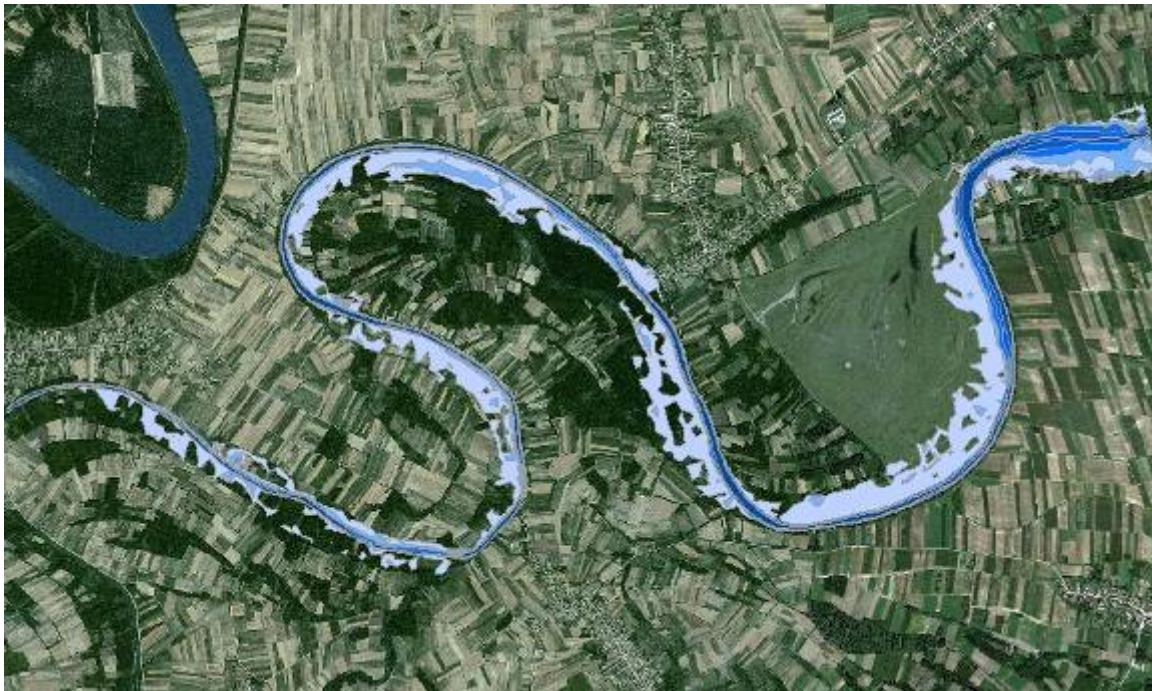
Karta 16. Detalj sa karte 13 sa različitim nivoima vode na brani 1 na profilu Valjevac: 75 m a.s.l. ; 75.5 m a.s.l. ; 76 m a.s.l. ; 76.5 m a.s.l. i 77 m a.s.l. sa protokom  $Q_{Y,med} = 0.21 \text{ m}^3/\text{s}$
